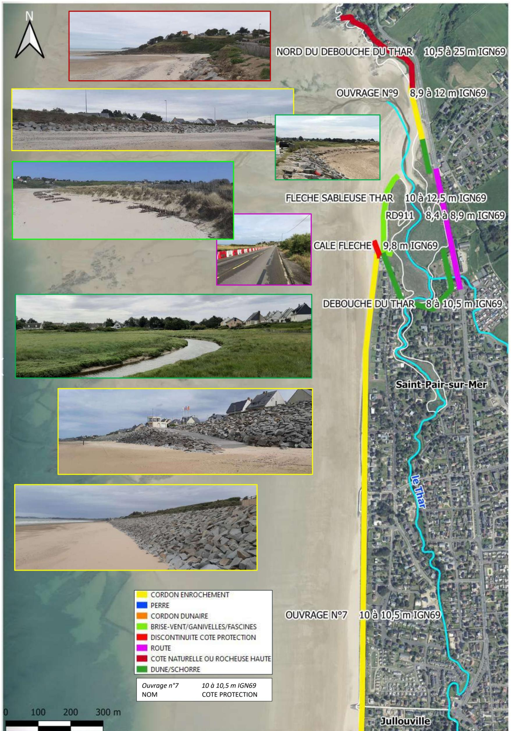
Figure 11 : Ouvrages de protection, secteurs non protégés et cotes de protection sur le secteur de Kairon-plage et du débouché du thar à Saint-Pair-sur-Mer.
